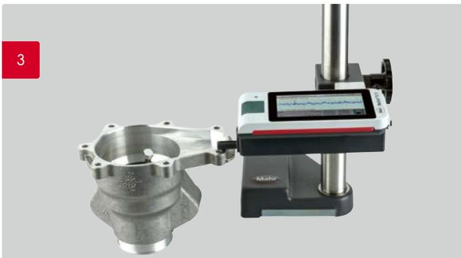
3. Mesure de la rugosité avec statif ST-D
