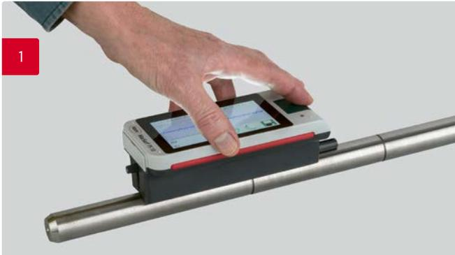
1. Mesure de la rugosité des arbres
